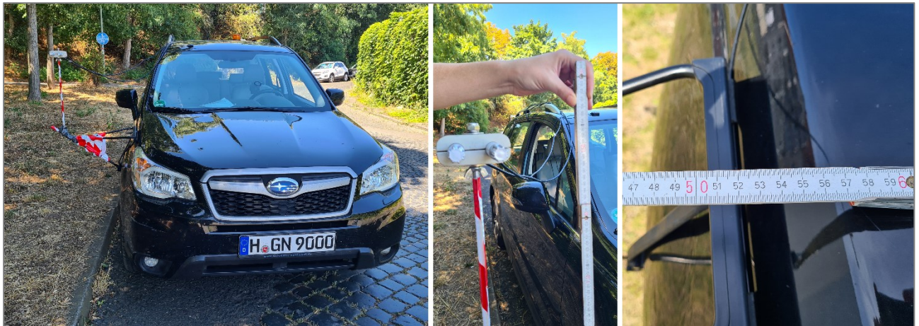
Abbildung 35: Anbringung des Temperatursensors für die Messfahrt am PKW (links), Höhe über Grund (Mitte) und seitlicher Abstand vom Fahrzeug (rechts).
